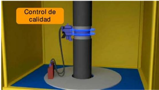
Se comprueban una a una las soldaduras mediante técnicas que preservan la calidad del material (Non Destructive Techniques).
