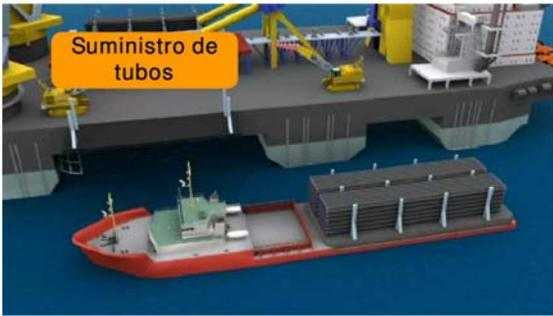
Cada tubo tiene una longitud de **12 metros** y un diámetro de **24 pulgadas (610 mm)**. Para su protección mecánica y anticorrosiva, los tubos llevan un revestimiento tricapa: una de resinas epoxídicas (contra la corrosión), otra de material adhesivo (para fijar el revestimiento) y una tercera de polipropileno (para proteger al tubo de golpes y rozaduras). En las zonas de poca profundidad recibirán, además, un revestimiento de hormigón para proteger al gasoducto de factores externos.
