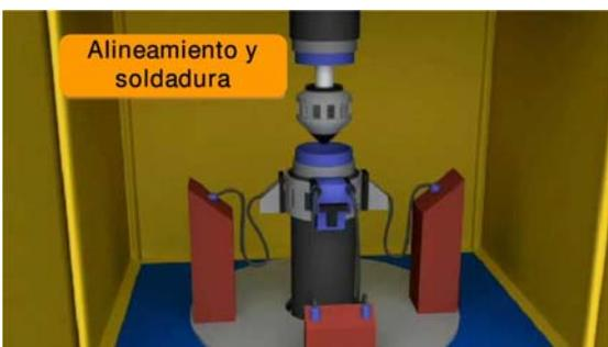
En la torre, se procede al alineamiento de los tubos, antes de su soldadura mediante arco eléctrico.
