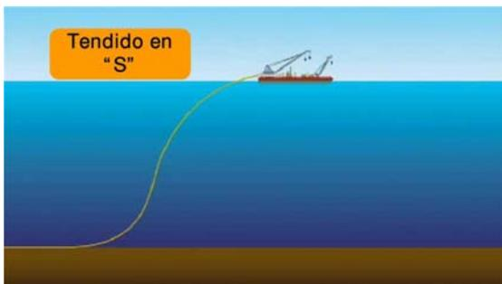
Para la construcción del gasoducto submarino se aplicará el sistema "Lay Barge". Se trata de utilizar una barcaza o plataforma móvil en la que se suelda la tubería antes de tenderla sobre el lecho marino.
