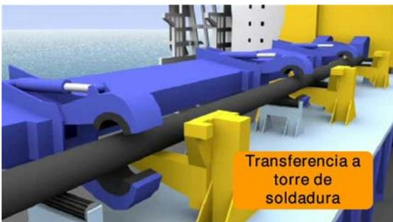
Una vez sobre la plataforma, los tubos son colocados en la parte central de la misma y elevados a la torre de soldadura, donde se procede a su unión.
