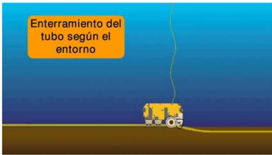
El gasoducto va tendido sobre el lecho marino, salvo en las zonas más cercanas a la costa, donde se entierra para proteger el gasoducto del tráfico marítimo u otros factores externos. Una máquina dragadora va haciendo la zanja en la que se entierra la tubería, que se rellena con un manto de roca graduada
